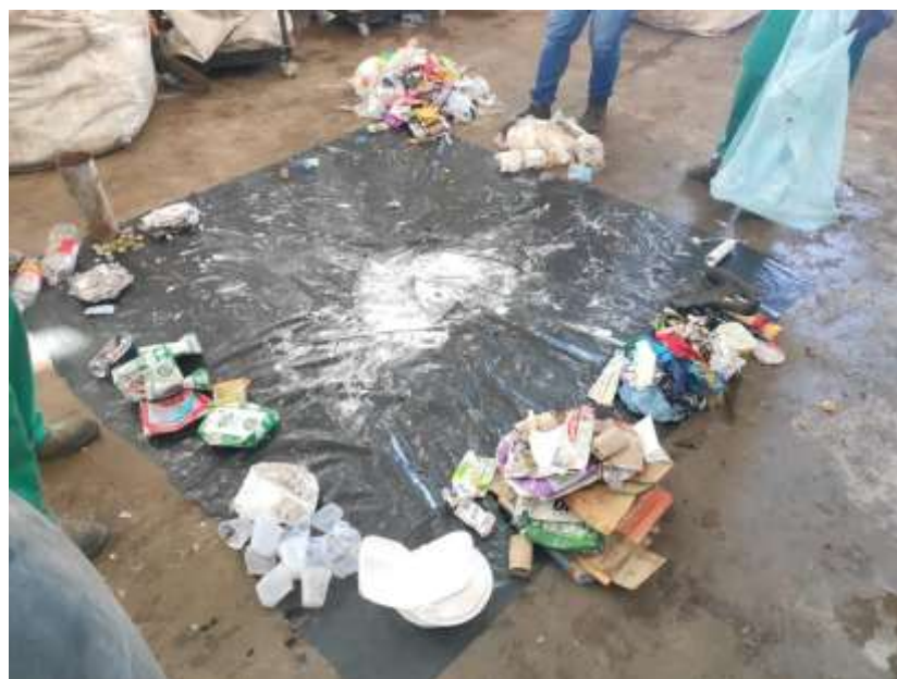
Figura 34-Separação para posterior pesagem em balança digital e classificação dos resíduos segundo sua tipologia para o estudo da composição gravimétrica dos resíduos do município de Três Barras do Paraná.
