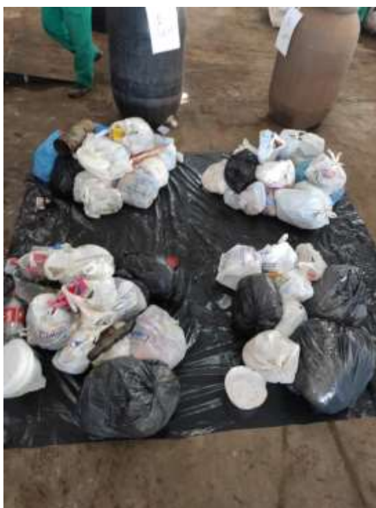
Figura 33-Divisão em quatro partes iguais e uma das partes foi escolhida de forma aleatória para a realização do estudo da composição gravimétrica.
