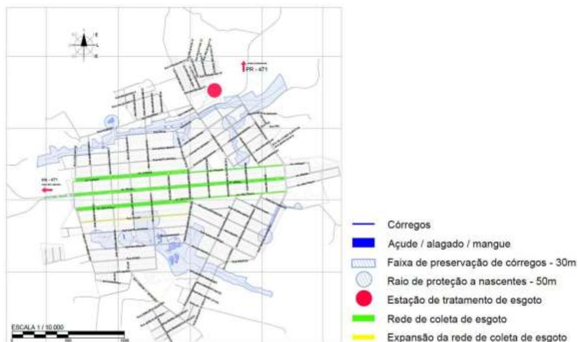
Figura 9 - Rede de Coleta de Esgoto
